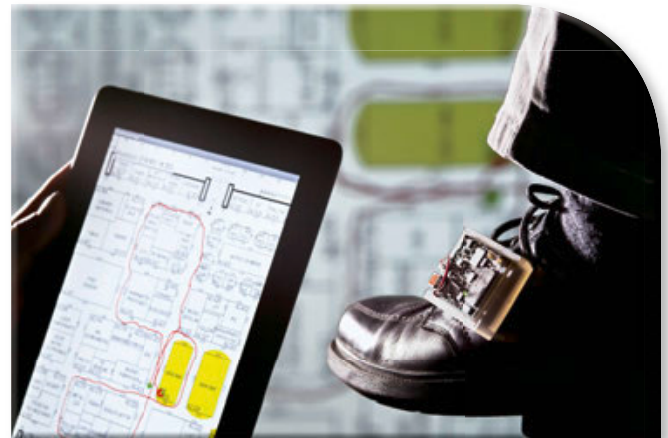
In- und Outdoor-Lokalisierung durch Sensorfusion Source: HSG-IMIT (Institut für Mikro- und Informationstechnik of the Hahn-Schickard-Gesellschaft e.V.)
